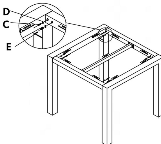
**Bitte das Gestell zuerst korrekt ausrichten und anschließend die Schrauben komplett festziehen**
